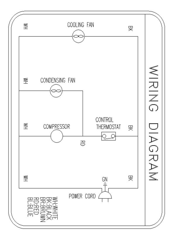
DD59, DD69, DD79, DD95 WIRING DIAGRAM
